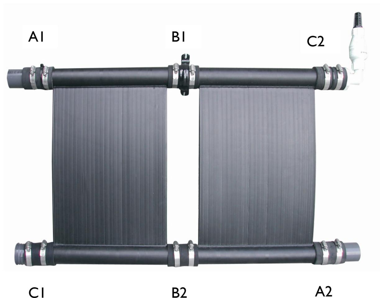
I raccordi TS1 e TS2 sono accessori indispensabili per il collegamento dei pannelli TS POOL. Nello specifico TS1 comprende n° 2 giunti di unione tra due collettori (B1+B2); per ogni pannello è necessario un TS1. TS2 contiene n° 2 tappi terminali e n° 2 raccordi 1"-1/2 lisci (C1+A1+A2+C2) indispensabili per collegare ogni batteria di pannelli costituita da massimo 7 collettori.
